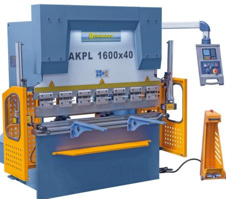
Die Bernardo AKPL 1600 x 40 Hydraulische Abkantpresse ist ein leistungsstarkes Werkzeug für die Metallverarbeitung. Mit einer Abkantlänge von 1600 mm und einer Druckkraft von 40 to ist sie ideal für das Biegen von Metallplatten. Die Maschine verfügt über eine Vorlaufgeschwindigkeit von 60 mm/sek., eine Biegegeschwindigkeit von 8 mm/sek. und eine Rücklaufgeschwindigkeit von 60 mm/sek.
