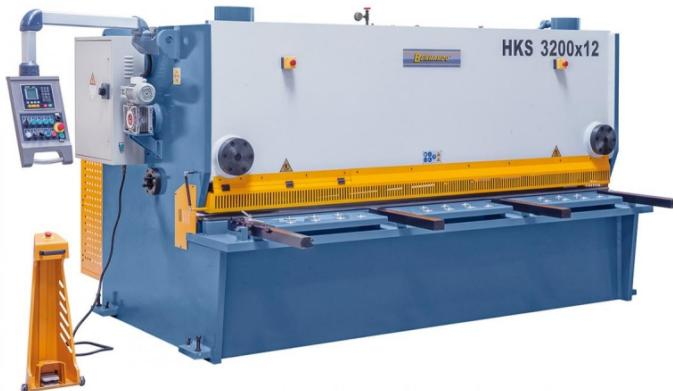
Die Bernardo HKS 3200 x 8 Hydraulische Kulissen-Tafelscheren ist eine leistungsstarke Maschine für die Metallverarbeitung. Mit einer Schnittlänge von 3200 mm und einer maximalen Blechstärke von 8 mm ist sie ideal für verschiedene Anwendungen. Die Maschine verfügt über einen motorischen Hinteranschlag, der zwischen 20 und 600 mm eingestellt werden kann.
