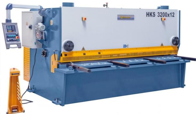
Die Bernardo HKS 3200 x 6 Hydraulische Kulissen-Tafelscheren ist eine leistungsstarke Maschine für die Metallverarbeitung. Mit einer Schnittlänge von 3200 mm und einer Maximalblechstärke von 6 mm ist sie ideal für verschiedene Anwendungen. Die Maschine verfügt über einen motorischen Hinteranschlag, der zwischen 20 und 600 mm eingestellt werden kann.
