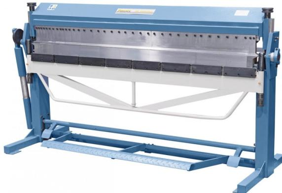
Die Bernardo TB 2050 Flex Schwenkbiegemaschinen mit segm. Ober-, Unter- und Biegewange sind universell einsetzbare Biegemaschinen für Spenglereien und Reparaturbetriebe. Durch Klaviereinsätze in der Ober-, Unter- und Biegewange ergibt sich eine große Anzahl von Biegemöglichkeiten. Kassetten und Spezialprofile mit entgegengesetzten Biegemöglichkeiten sind mit diesen Modellen leicht durchführbar.
