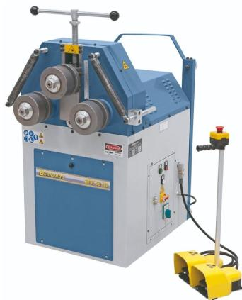
Die Bernardo BPK 50 N2 mit 2 Biegegeschwindigkeiten ist eine motorische Ringbiegemaschine. Diese Maschine ist für die Bearbeitung von Metall und anderen Materialien konzipiert. Die technischen Daten dieser Maschine sind wie folgt:
