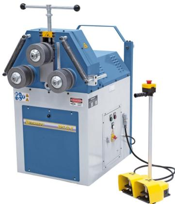
Die Bernardo BPK 50 N Motorische Ringbiegemaschinen ist eine leistungsstarke Maschine für die Biegebearbeitung von Rohren und Profilen. Die Maschine verfügt über eine Motorleistung von 1,5 kW und eine Biegeschwindigkeit von 4,5 m/min. Die Walzendurchmesser betragen 155 mm und der Wellendurchmesser 50 mm.
