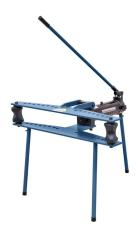
Der Bernardo HRB 40 S Hydraulischer Rohrbieger ist ein leistungsstarkes Werkzeug für die Bearbeitung von Rohren. Die Kapazität des Geräts reicht von 1/2" bis 4". Es kann verschiedene Biegeformen von 1/2" bis 4" und Wandstärken von 2,75 bis 6 mm bearbeiten. Die Druckleistung beträgt 22 to und das Gewicht ca. 150 kg.
