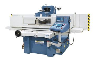
Das Modell BSG 40100 PLC eignet sich für die Bearbeitung von Werkstücken bis 600 kg und einer Schleiffläche bis 1130 x 450 mm. Durch die umfangreiche Serienausstattung wie z.B.: Computergesteuerte Vertikalzustellung, Parallelabzieh- vorrichtung mit Mikrometerverstellung, Magnetplatte mit Entmagnetisierungseinrichtung sowie der 2-Achs- Digitalanzeige bietet dieses Modell ein optimales Leistungspaket für den Anwender.
