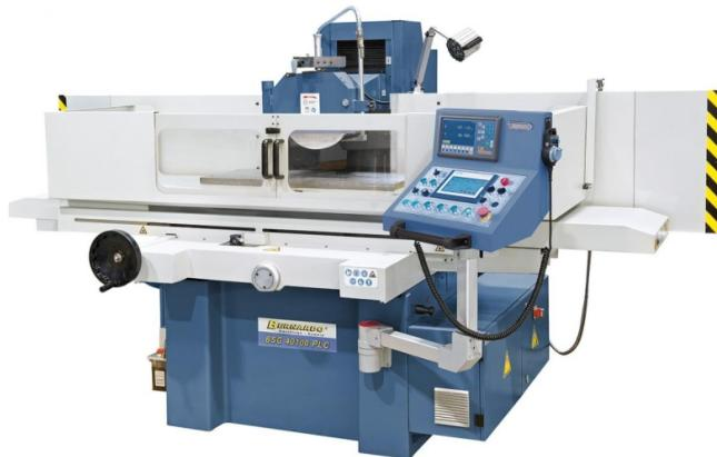
Das Modell BSG 40100 PLC eignet sich für die Bearbeitung von Werkstücken bis 600 kg und einer Schleiffläche bis 1130 x 450 mm. Durch die umfangreiche Serienausstattung wie z.B.: Computergesteuerte Vertikalzustellung, Parallelabzieh- vorrichtung mit Mikrometerverstellung, Magnetplatte mit Entmagnetisierungseinrichtung sowie der 2-Achs- Digitalanzeige bietet dieses Modell ein optimales Leistungspaket für den Anwender.
