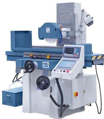
Die massiv gebauten Flachschleifmaschinen der FSM-AHD-Serie sind serienmäßig mit einer automatischen Vertikalzustellung ausgestattet. Durch die umfangreiche Serienausstattung wie z.B. computergesteuerte Vertikalzustellung, Magnetplatte mit Entmagnetisierungseinrichtung, Steuerung über Touchscreen sowie einem elektronischen Handrad bieten diese Modelle ein optimales Leistungspaket für den Anwender.
