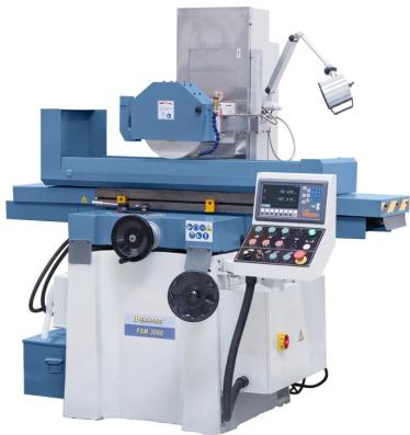
Die Flachschleifmaschine FSM 3060 überzeugt durch ihre robuste Bauweise. Alle Hauptbaugruppen wie Ständer, Sockel und Schlitten sind aus hochwertigem Guss hergestellt. Durch das umfangreiche Standardzubehör bietet dieses Modell ein optimales Leistungspaket für den Werkzeug- und Formenbau.
