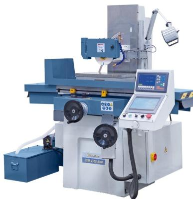
Die massiv gebauten Flachschleifmaschinen der FSM-AHD-Serie sind serienmäßig mit einer automatischen Vertikalzustellung ausgestattet. Durch die umfangreiche Serienausstattung wie z.B. computergesteuerte Vertikalzustellung, Magnetplatte mit Entmagnetisierungseinrichtung, Steuerung über Touchscreen sowie einem elektronischen Handrad bieten diese Modelle ein optimales Leistungspaket für den Anwender.
