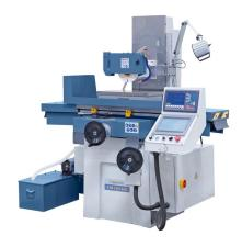
Die massiv gebauten Flachschleifmaschinen der FSM-AHD-Serie sind serienmäßig mit einer automatischen Vertikalzustellung ausgestattet. Durch die umfangreiche Serienausstattung wie z.B. computergesteuerte Vertikalzustellung, Magnetplatte mit Entmagnetisierungseinrichtung, Steuerung über Touchscreen sowie einem elektronischen Handrad bieten diese Modelle ein optimales Leistungspaket für den Anwender.
