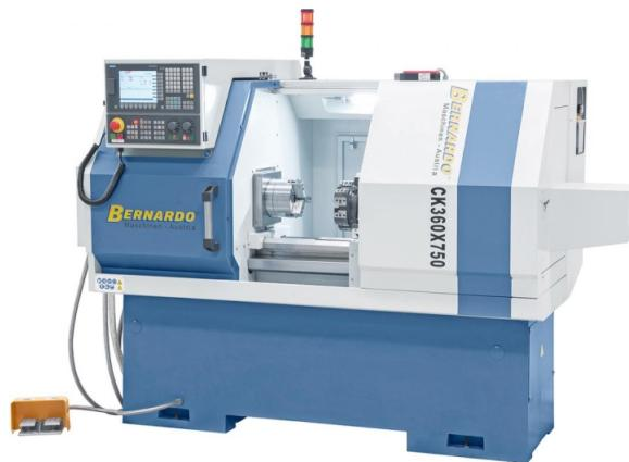
Die Bernardo CK 360 x 750 CNC-Drehmaschinen sind für präzise Dreharbeiten konzipiert. Sie verfügen über eine Spitzenweite von 750 mm und eine Spitzenhöhe von 180 mm. Die Maschinen sind mit einer elektronischen Handradsteuerung für manuelles Verfahren in x- und z-Achse ausgestattet.
