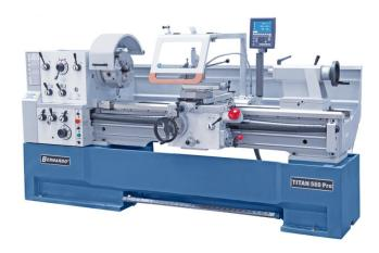
Die Produktionsdrehmaschine Titan 560 Pro wurde speziell zum wirtschaftlichen Herstellen von Einzelwerkstücken konzipiert. Schon die Grundausstattung beinhaltet alle wichtigen Zubehöre, wodurch diese Maschine universell einsetzbar ist.
