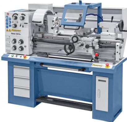
Die Universaldrehmaschine Master 330 Pro eignet sich zur Ausführung von leichten und mittelschweren Dreharbeiten. Schon die Grundausstattung beinhaltet alle wichtigen Zubehörteile, wodurch diese Maschine universell einsetzbar ist. Zur Reduzierung der Fertigungszeiten ist dieses Modell auch mit einer 3-Achs-Digitalanzeige lieferbar.
