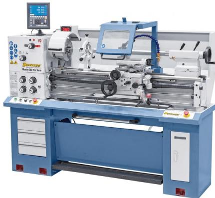
Die Master 360 Pro Vario ist eine kompakt gebaute Universaldrehmaschine mit großem Einsatzbereich und überzeugt vor allem durch den Drehdurchmesser von 360 mm, sowie der Spindelbohrung von 52 mm. Aufgrund ihrer Konstruktion kann sie sowohl in Ausbildungswerkstätten, aber auch für den Werkzeugbau und Reparaturbetriebe erfolgreich eingesetzt werden. Zusätzlich ist dieses Modell serienmäßig mit einer variablen Drehzahlregelung für ein optimales Einstellen der Schnittgeschwindigkeit ausgestattet.
