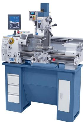
Das Bearbeitungszentrum Proficenter 600 G ist serienmäßig mit einer Leit- und Zugspindel zum Gewindeschneiden bzw. für den automatischen Längs- und Planvorschub ausgestattet. Durch das 12-Stufen-Schaltgetriebe wird ein schnelles Einstellen der Drehzahlen ermöglicht - kein Keilriemenwechsel notwendig. Die Maschine ist serienmäßig mit einer digitalen Positionsanzeige Bernardo ausgestattet.
