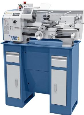
Die kompakte Leitspindeldrehmaschine Profi 450 S / Profi 450 S Vario überzeugt durch ihre moderne Bauweise und dem leistungsstarken Antriebsmotor für hohes Drehmoment. Durch das überzeugende Preis-Leistungsverhältnis ist dieses Modell ideal für Modellbauer und Hobby-Heimwerker.
