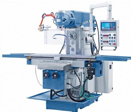
Die Universalfräsmaschine UWF 200 Servo ist für die Bearbeitung von Werkstückgewichten bis 300 kg ausgelegt. Durch die stabile und schwere Graugusskonstruktion und der hohen Steifigkeit der Maschinenbaugruppen erfüllt dieses Modell die besten Voraussetzungen für genaues Arbeiten. Hauptmerkmale dieser Maschine sind der Servoantrieb mit elektronischen Handrädern in allen Achsen sowie die stufenlose Drehzahlregelung.
