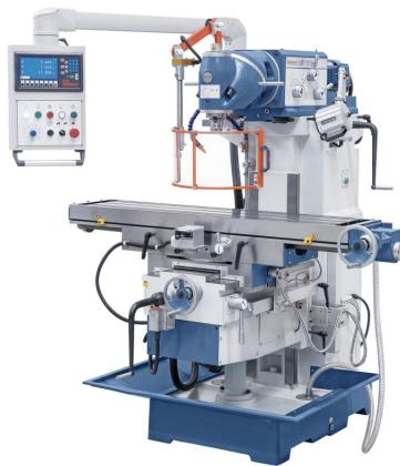
Die Universalfräsmaschine UWF 110 Servo eignet sich zur Ausführung von leichten und mittelschweren Fräsarbeiten. Dank ihrer großen Vielseitigkeit und der einfachen Umrüstung kann sie in Werkstätten zur Bearbeitung von kleinen und mittelgroßen Serien mit Erfolg eingesetzt werden. Besondere Merkmale dieser Maschine sind der schwenkbare Arbeitstisch, die Flachführung in y- und z-Achse und der Servoantrieb für Vorschübe und Eilgang in allen Achsen.
