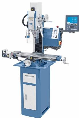
Die Bohr- und Fräsmaschine KF 28 Top ist serienmäßig mit einem hochwertigem Gleichstrommotor ausgestattet. Wesentliche Vorteile, die sich daraus ergeben, sind das hohe Drehmoment im unteren Drehzahlbereich und die annähernd konstante Drehzahl unter Last. Ihren Einsatzbereich findet dieses Modell hauptsächlich beim professionellen Anwender, im Modellbau, aber auch im Ausbildungsbereich.
