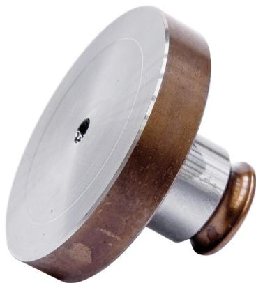
Durch die Einstellhilfe 90° kann die Gewindeschneidmaschine immer exakt rechtwinklig zum Werkstück eingestellt werden.
