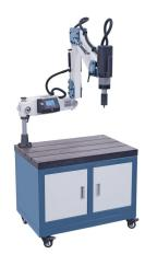
Die Bernardo TM 36 E / R 1700 ist eine Elektrische Gewindeschneidmaschine, die für Gewindebohrungen im Bereich von M5 bis M36 geeignet ist. Die Maschine verfügt über eine verstellbare Drehzahl von 30 bis 150 U/min und einen verstellbaren Winkel von 0° bis 90°. Die Reichweite der Maschine beträgt R 1700 mm. Die Maschine ist mit einem Schnellwechselfutter ausgestattet, das die Verwendung von verschiedenen Futtergrößen ermöglicht.
