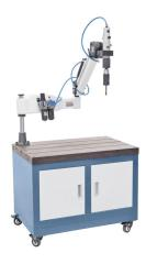
Die Bernardo TM 24 P / R 1100 Pneumatische Gewindeschneidmaschinen sind für Gewindebohrungen im Bereich von M5 bis M24 geeignet. Die Maschinen verfügen über eine Drehzahl von 400 U/min und einen verstellbaren Winkel von 0° bis 90°. Der maximale Arbeitsradius beträgt R 1100 mm. Die Maschinen benötigen einen Luftdruck von 6 - 8 bar und sind mit einem Schnellwechselfutter nach DIN 376 ausgestattet, das für verschiedene Gewindegrößen von M5 bis M24 geeignet ist.
