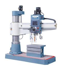
Die Radialbohrmaschine RD 1600 NC ist für Bohr-, Senk- und Reibarbeiten von großen Werkstücken ideal geeignet. Die Besonderheiten dieses Modells sind die Bedienung über einen großdimensionierten Touchscreen sowie der Pinolenvorschub mittels Servomotor. Durch die vielseitigen Anwendungsmöglichkeiten ist diese Maschine optimal für mechanische Werkstätten, Reparaturbetriebe, Maschinenbau.
