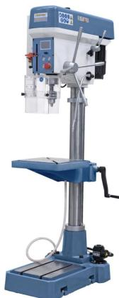
Die Bernardo DMC 32 TSV Vario-Tisch- und Säulenbohrmaschinen sind robuste und leistungsstarke Bohrmaschinen für hohe Beanspruchung. Sie verfügen über einen oberflächenbearbeiteten Arbeitstisch, der höhenverstellbar ist und eine stufenlos regelbare Drehzahl bietet, ideal zum Einstellen der gewünschten Schnittgeschwindigkeit.
