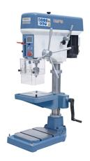
Die Bernardo DMT 20 TSV Vario-Tisch- und Säulenbohrmaschinen sind für präzise Bohrarbeiten konzipiert. Mit einer Bohrleistung von maximal 20 mm und einer Gewindeschneidefähigkeit von bis zu M 16, bietet diese Maschine eine hohe Flexibilität. Der Morsekegel MK 2 und die Spindeldrehzahl von 205 – 2045 U/min ermöglichen eine Vielzahl von Anwendungen.
