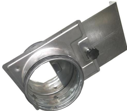
Der Schieber S2H 100 ist für Rohrdurchmesser 125 mm passend und dient als Absperrung, die händisch mit integrierter Dichtung bedient wird. Achtung, dieser Teil ist eine händische Sonderfertigung, dadurch ergeben sich mitunter leichte Abweichungen, die kein Reklamationsgrund sind. Häufige Verwendung in Verbindung mit der Reduzierung und einer Montageschelle vor und nach dem Schieber.
