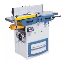
Die Maschine mit dem optimalen Preis-Leistungsverhältnis für den professionellen Heimwerker. Forderungen wie Stabilität, hohe Leistungsreserven und Sicherheit sind bei diesem Modell selbstverständlich. Die Spiralmesser-Hobelwelle für eine verminderte Lärmbelastung und optimale Hobelergebnisse ist ein weiteres Plus dieser Maschine.
