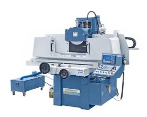
Die massiv gebauten Flachschleifmaschinen der BSG-Serie sind serienmäßig mit einer automatischen Vertikalzustellung ausgestattet. Alle Hauptbaugruppen wie Ständer, Sockel und Schlitten sind aus hochwertigem Guss hergestellt. Durch das umfangreiche Standardzubehör bieten diese Modelle ein optimales Leistungspaket für den Werkzeug- und Formenbau.
