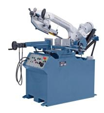
Das Modell MBS 300 DGA ist eine kostengünstige Doppelgehrungs-bandsäge zum Schneiden von Hohlprofilen, Vollmaterialien, Edelstahl, Werkzeugstahl usw. Durch die halbautomatische Funktionsweise wird die Produktivität zusätzlich erhöht und ist daher die ideale Maschine für den professionellen Anwender.
