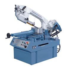
Das Modell MBS 530 DG ist eine präzise Horizontalbandsäge für den universellen Einsatz. Die Merkmale dieser Maschine sind der schwenkbare Sägebügel für Doppelgehrungsschnitte von -45° bis +60°, sowie ein Hydraulikzylinder zum feinfühligen Absenken mittels Regelventil. Ihren Einsatzbereich findet diese Maschine in Schlossereien, Reparaturbetrieben, im Formen- und Werkzeugbau.
