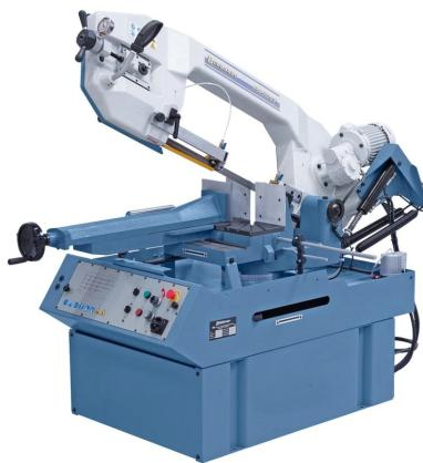
Das Modell MBS 530 DG ist eine präzise Horizontalbandsäge für den universellen Einsatz. Die Merkmale dieser Maschine sind der schwenkbare Sägebügel für Doppelgehrungsschnitte von -45° bis +60°, sowie ein Hydraulikzylinder zum feinfühligen Absenken mittels Regelventil.
