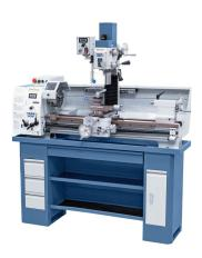
Das Bearbeitungszentrum Proficenter 900 Vario ist aufgrund der umfangreichen Grundausstattung (z.B.: Fräsaufsatz, Drehstrommotor mit Frequenzumrichter, Hauptspindellagerung in P5-Qualität, Mikrometerlängsanschlag, Rutschkupplung, LED-Maschinenleuchte,....) die ideale Maschine für den anspruchsvollen Anwender. Zur Reduzierung der Fertigungszeiten ist dieses Modell auch mit einer 2-Achs-Digitalanzeige lieferbar.
