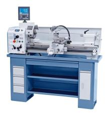
Die Vario-Drehmaschine Profi 880 G Vario ist serienmäßig mit einem Vorgelege ausgestattet, wodurch ein Wechseln der Drehzahlstufe mittels Keilriemen entfällt. Ein weiteres Merkmal dieser Maschine ist der serienmäßige Frequenzumrichter, wodurch ein hohes Drehmoment im unteren Drehzahlbereich und eine annähernd konstante Drehzahl unter Last gewährleistet wird.
