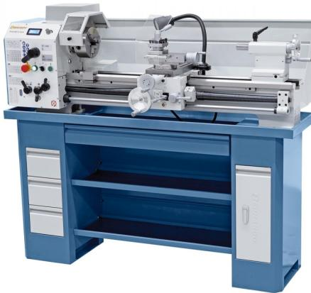
Die Vario-Drehmaschine Profi 880 G Vario ist serienmäßig mit einem Vorgelege ausgestattet, wodurch ein Wechseln der Drehzahlstufe mittels Keilriemen entfällt. Ein weiteres Merkmal dieser Maschine ist der serienmäßige Frequenzumrichter, wodurch ein hohes Drehmoment im unteren Drehzahlbereich und eine annähernd konstante Drehzahl unter Last gewährleistet wird.
