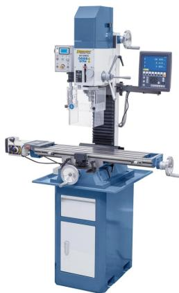
Die Bohr- und Fräsmaschine BF 35 BDC ist aufgrund der hohen Drehzahl bis 3000 U/min, dem leistungsstarkem Antriebsmotor (1,5 KW) und der Spindelaufnahme MK 3 das ideale Modell für den anspruchsvollen Anwender.
