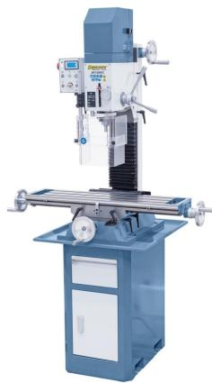
Die Bohr- und Fräsmaschine BF 35 BDC ist aufgrund der hohen Drehzahl bis 3000 U/min, dem leistungsstarken Antriebsmotor (1,5 KW) und der Spindelaufnahme MK 3 das ideale Modell für den anspruchsvollen Anwender. Zur Reduzierung der Fertigungszeiten ist dieses Modell auch mit einer 3-Achs-Digitalanzeige und einem stufenlos regelbaren Frästischvorschub lieferbar.
