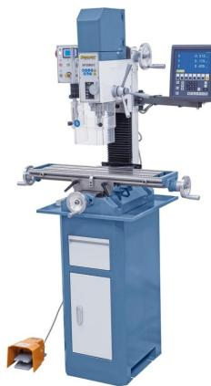
Die Bohr- und Fräsmaschine BF 28 BDC ist serienmäßig mit einem hochwertigem Gleichstrommotor ausgestattet. Wesentliche Vorteile, die sich daraus ergeben, sind das hohe Drehmoment im unteren Drehzahlbereich und die annähernd konstante Drehzahl unter Last. Ihren Einsatzbereich findet dieses Modell hauptsächlich beim professionellen Anwender, im Modellbau, aber auch im Ausbildungsbereich.
