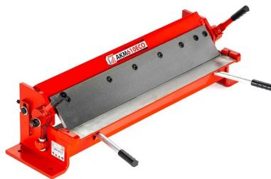
Die Holzmann AKM610ECO Abkantmaschine bietet eine solide Konstruktion mit hochwertigen Abkantelementen für ein Höchstmaß an Präzision. Das komfortable Exzenterspannsystem und die segmentierte obere Biegeeinheit mit verschiedenen breiten Abkantelementen (1", 2", 3", 8", 10") ermöglichen die Bearbeitung unterschiedlicher Werkstückgrößen. Die Abkantelemente sind beliebig verschieb- und zusammensetzbar. Befestigungsbohrungen ermöglichen die Montage auf der Werkbank oder passenden Maschinenständern.
