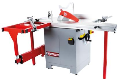
Die Holzmann TS315F1600\_400V Formatkreissäge ist eine leistungsstarke Maschine für die Holzbearbeitung. Sie verfügt über ein schwenkbares und höhenverstellbares Kreissägeblatt, ein 1600 mm langes Formatschiebetisch mit Unterstützungsrolle am Ausleger und ein starkes Graugusstisch für eine lange Lebensdauer. Die Sägeblatt mit Ø315mm ermöglicht eine Schnitthöhe von bis zu 85mm.
