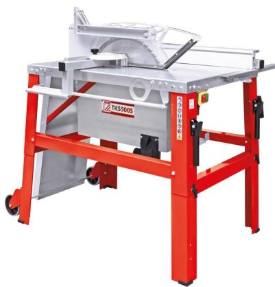
Die Holzmann TKS500S\_400V Tischkreissäge ist ideal für den Einsatz auf der Baustelle geeignet. Sie bietet eine große Schnitthöhe von 150mm dank 500mm HW-Sägeblatt und einen stabilen Grundrahmen mit Tischverlängerung (Klapptbar). Der leistungsstarke Motor und die Querschneidlehre mit integrierter Keilschneidlehre + Parallelanschlag/Längsanschlag unterstützen sicheres und präzises Arbeiten.
