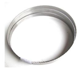
Das Bandsägeblatt A-BSB550SMARTB32 ist für die Blochbandsäge BBS550SMART konzipiert und eignet sich für die Bearbeitung von Nadelholz, europäischem Laubholz und teilweise tropischem Hartholz. Es ist besonders verlässlich bei härteren Holzarten. Die Ausführung zeichnet sich durch gehärtete Zahnspitzen, Verzahnung, Schränkung, Schleifung und einen gerichteten Blattrücken aus. Das Blatt ist nachschärfbar.
