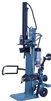
Die Holzspalter der HS-Serie sind wahlweise mit einem Zapfwellenantrieb bzw. kombiniertem Elektro-/Zapfwellenantrieb erhältlich. Ausgereifte technische Lösungen wie z.B. die Zweihand-Sicherheitsbedienung, die hohe Vorlaufgeschwindigkeit für schnelles Arbeiten, der stufenlos einstellbare Spalthub sowie der serienmäßige Stammheber bei allen Modellen zeichnen diese Serie aus.
