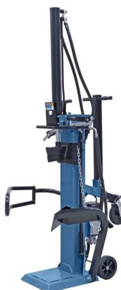
Der Holzspalter HS 11 E zeichnet sich durch ausgereifte technische Lösungen wie z.B. die Zweihand-Sicherheitsbedienung, der hohen Vorlaufgeschwindigkeit für schnelles Arbeiten, dem stufenlos einstellbaren Spalthub sowie dem serienmäßigem Stammheber aus.
