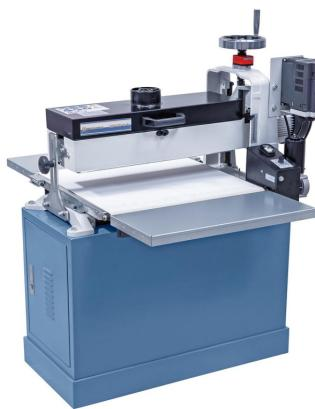
Die Zylinderschleifmaschine ZSM 560 Vario ist für Schleifarbeiten bis 1120 mm Breite geeignet. Die Vorschubgeschwindigkeit des Förderbandes kann stufenlos an das Werkstück angepasst werden, wodurch optimale Schleifergebnisse erzielt werden. Zusätzlich ist dieses Modell mit einer stufenlos einstellbaren Schleifgeschwindigkeit ausgestattet.
