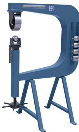
Die Bernardo RSM 700 x 1,5 Rollenstreckmaschinen sind ideal zum Herstellen von konvexen und konkaven Blechteilen wie z.B. Kotflügel, Türen, Hauben usw. Die leichte Entnahme des fertigen Werkstückes durch Schnellhebemechanismus an der unteren Formrolle erleichtert den Arbeitsprozess. Serienmäßig mit 5 Stk. Formrollen zum Herstellen verschiedenster Radien ausgestattet, bietet diese Maschine eine hohe Flexibilität.
