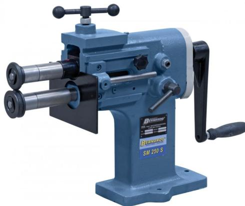
Die Bernardo SM 250 S Manuelle Sickenmaschinen sind zum Herstellen von verschiedenen Sickenarten geeignet. Sie bieten präzise Lagerung der Wellen und eine stabile Gusskonstruktion in moderner Ausführung. Der erweiterte Einsatzbereich wird durch 8 verschiedene, optional erhältliche Walzenpaare ermöglicht. Die Maschinen sind inklusive Sicken- und Bördelwalzen, verstellbarem Anschlag auf der unteren Welle und oberer Welle verstellbar.
