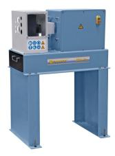
Der Bernardo MRA-Pro Rohrausklinker ist ein leistungsstarkes Gerät für die Bearbeitung von Rohren. Die Maschine ist in der Lage, Rohre mit verschiedenen Durchmessern zu bearbeiten, von 16 mm bis 60 mm. Die maximale Wandstärke, die bearbeitet werden kann, variiert je nach Material: 4,5 mm für Aluminium, 4,0 mm für Kupfer und Messing, 3,0 mm für Baustahl und 2,0 mm für Edelstahl.
