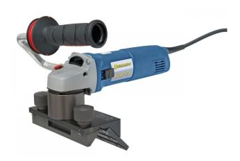
Die Kantenfräsmaschine KFM 175 wurde speziell zum Entgraten, zur Anarbeitung von optischen Fasen und zur wirtschaftlichen Schweißnahtvorbereitung von geraden Kanten konzipiert. Durch die in der Führungsschiene integrierten Laufrollen wird ein gleichmäßiger Vorschub beim Arbeiten gewährleistet.
