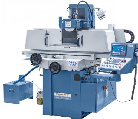
Die massiv gebauten Flachschleifmaschinen der BSG-Serie sind serienmäßig mit einer automatischen Vertikalzustellung ausgestattet. Alle Hauptbaugruppen wie Ständer, Sockel und Schlitten sind aus hochwertigem Guss hergestellt. Durch das umfangreiche Standardzubehör bieten diese Modelle ein optimales Leistungspaket für den Werkzeug- und Formenbau.
