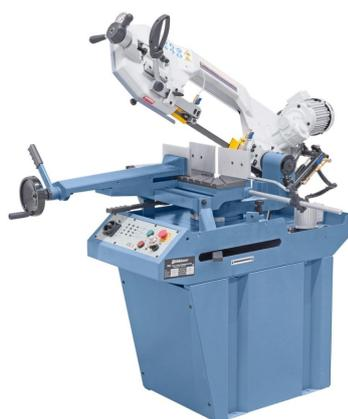
Das Modell MBS 280 DG-V PRO ist eine präzise Horizontalbandsäge für den universellen Einsatz. Die Merkmale dieser Maschine sind der schwenkbare Sägebügel für Doppelgehrungsschnitte von  $-45^\circ$  bis  $+60^\circ$ , sowie ein Hydraulikzylinder zum feinfühligem Absenken mittels Regelventil. Das Modell verfügt zusätzlich über eine stufenlos regelbare Schnittgeschwindigkeit.
